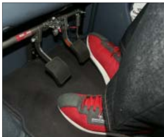
Bremsbereit: Mit der zweiten Pedalerie kann Burkhard gefährliche Situationen entschärfen.
